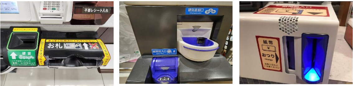
写真3 紙幣投入口の向きのちがい（横向き/長辺・横向き/短辺・縦向き/短辺）
